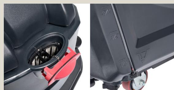
Снимите красную крышку и заполните бак водой, максимальная температура которой должна быть 40°C. Добавьте подходящее низкопенное моющее средство. Максимальный объем бака 85 л. Проверьте уровень по красному шарик индикатора уровня на боковой стороне машины.
