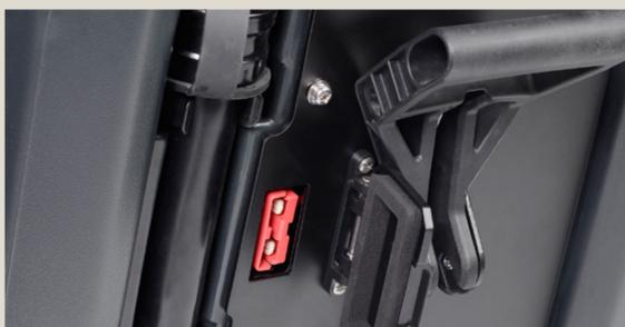
**Ежедневно:** Для зарядки аккумулятора, подсоедините разъем зарядного устройства к внешнему гнезду зарядного устройства машины, после чего подключите зарядное устройство к электрической розетке. Проверьте индикатор зарядного устройства, чтобы убедиться, что зарядка началась. Если машина поставляется со встроенным зарядным устройством, наклоните бак грязной воды, подключите встроенное зарядное устройство аналогичным способом.
