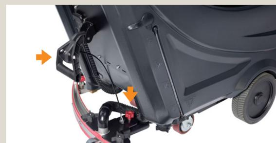
Для подъема или опускания скребка пользуйтесь ручкой. При помощи регулировочного барашка, если необходимо, отрегулируйте угол наклона скребка для лучшего сбора воды.
