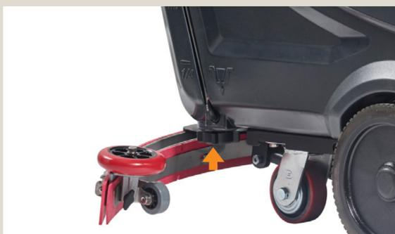
**Ежедневно:** Слейте воду из бака чистой воды с помощью пробки для слива, которая расположена внизу машины.
