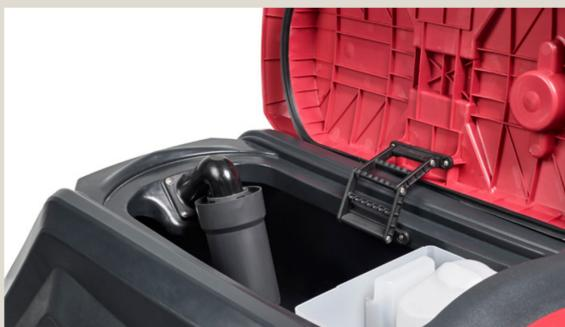
**Ежедневно:** Осмотрите и промойте поплавковую камеру. Осмотрите, проверьте и очистите лоток для мусора и при необходимости очистите прокладку крышки.
